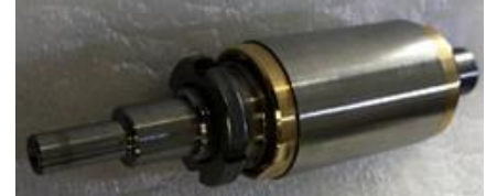
Fig. 7 Input rotor of MMSG.
